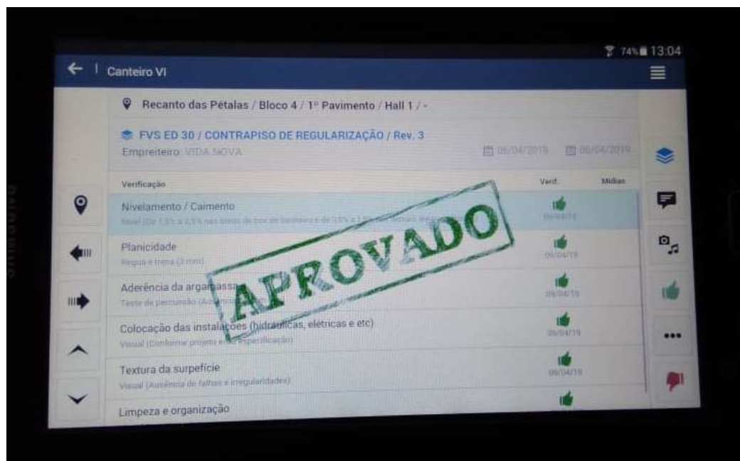
Figura 6: Conferência do contrapiso.
