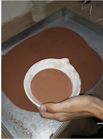
Preparação da amostra para ensaios de LL e LP
