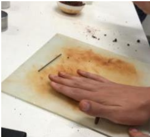
LP: Moldagem dos cilindros de solo com aproximadamente 3mm de diâmetro
