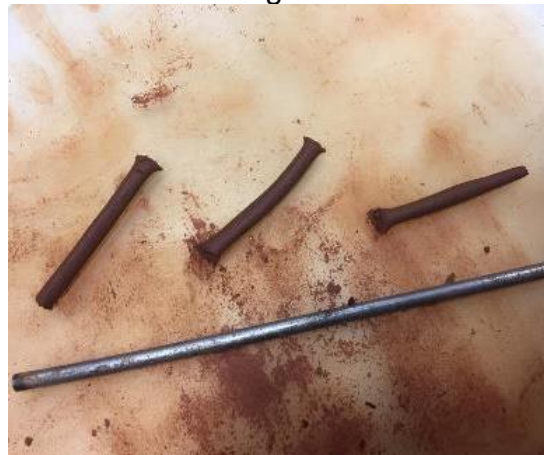
LP: Moldagem dos cilindros de solo com aproximadamente 3mm de diâmetro
