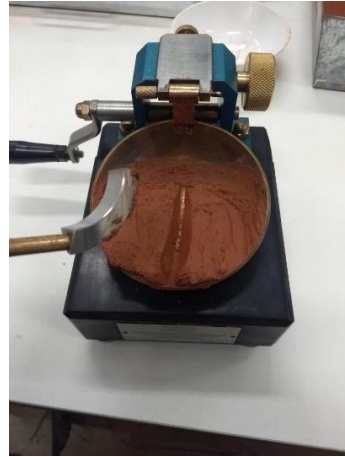
LL: Amostra homogênea com água conformada no aparelho de Casagrande
