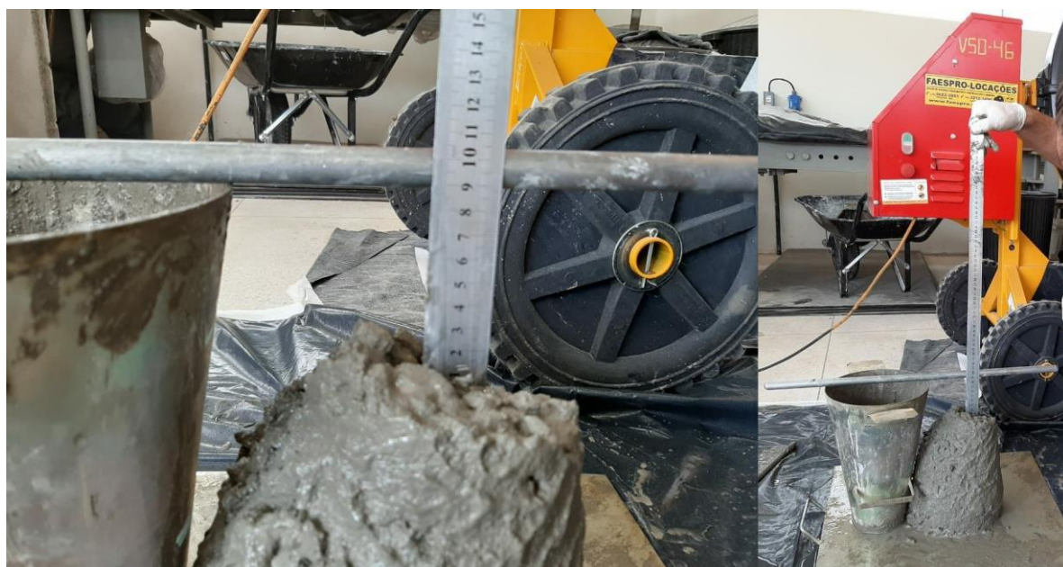
Figura 38: Determinação do abatimento do tronco de cone.
