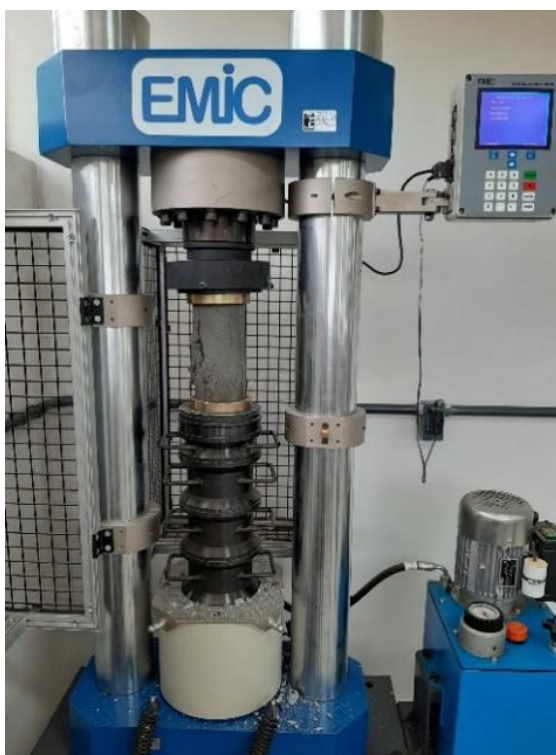
Figura 41: Ensaio de resistência à compressão em prensa hidráulica.
