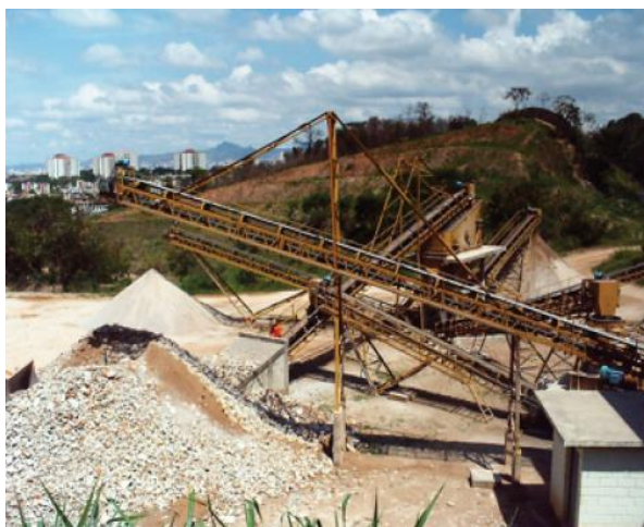
Figura 5: Usina para reciclagem de entulhos.
