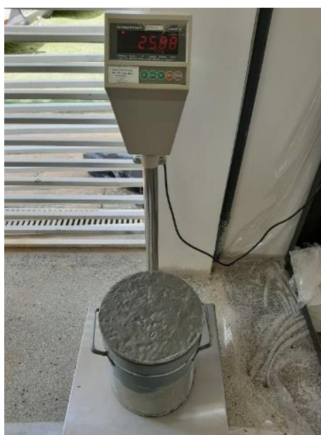
Figura 37: Determinação da massa específica do concreto fresco.
