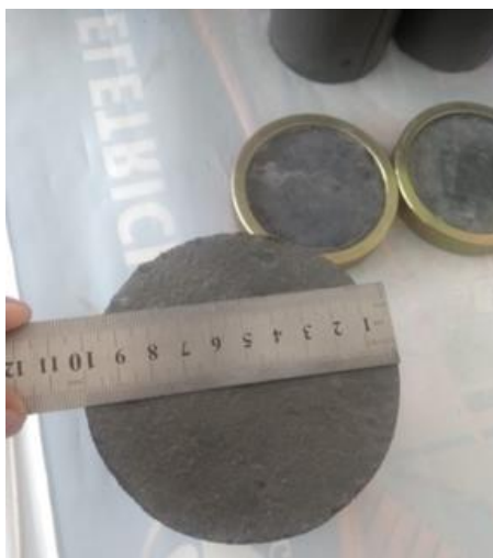
Figura 40: Corpos de prova para ensaios de resistência à compressão
