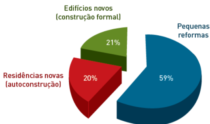
Figura 1: Fontes geradoras dos resíduos da construção e demolição.
