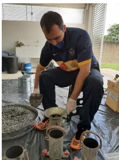
(a) Preenchimento do molde cilíndrico
