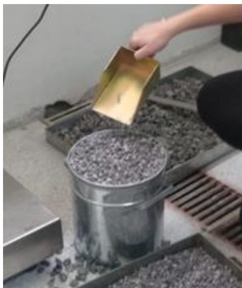
(a) Preenchimento do recipiente cilíndrico com agregado.
