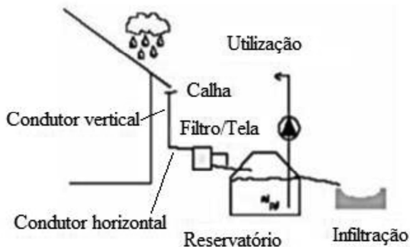
Figura 16 - Sistema de reaproveito pluvial com infiltração no solo.
